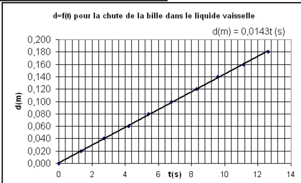
3°) Suite aux différents expériences nous pouvons conclure en disant que la bille a **un mouvement rectiligne uniforme**. Il faut préciser qu'avant d'atteindre ce mouvement rectiligne uniforme, la bille avait au départ un mouvement rectiligne accéléré, c'est pour cela que le liquide vaisselle dépassait la première graduation (ce qui empêche de réaliser des mesures au début et donc ne pas parler de ce mouvement rectiligne accéléré).
