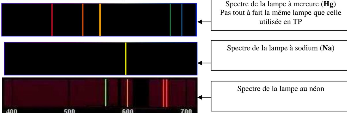
Pour les lampes à gaz (mercure, sodium, néon...) nous avons un spectre constitué d'un nombre restreint de radiations (toutes séparées de bandes noires) : il s'agit de **spectres de raies d'émission**. Ce qui n'est pas le cas pour la lampe à filament où nous avons un **spectre continu** (aucune bande noire entre les couleurs).
