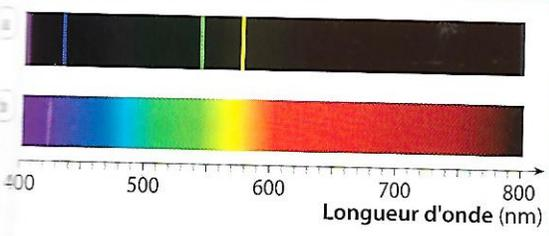
Spectres du mercure (a) et du cadmium (b) obtenus avec un spectrophotomètre
