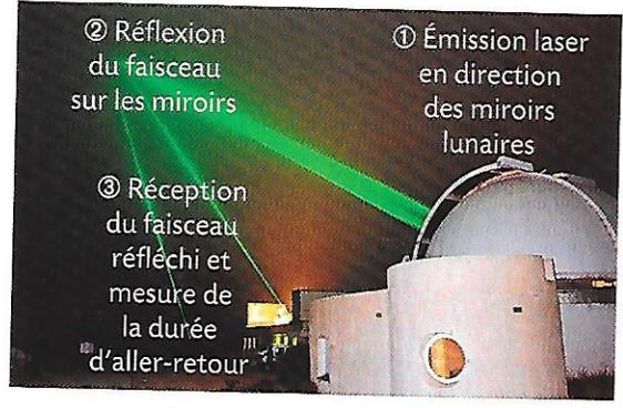
Une mesure a donné pour l'aller-retour de la lumière une durée  $\Delta t = 2,429\ 227\ 864\ 1\ \text{s}$  avec une précision de  $3 \times 10^{-10}\ \text{s}$ .
