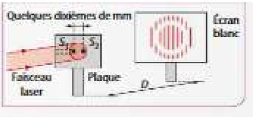
Le dispositif des trous d'Young est formé d'une plaque opaque percée de deux trous  $S_1$  et  $S_2$  très petits et très proches distant de  $b$ . On éclaire ce dispositif avec un laser de longueur d'onde  $\lambda$  et on place un écran à une distance  $D$  très grande devant  $b$ . On observe un disque haché au milieu et un cercle découpé, les deux séparés par des franges brillantes et sombres (voir figure ci-contre)
