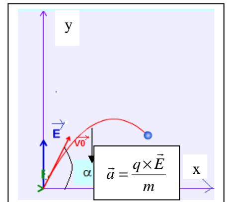
$$\begin{cases} a_x = \frac{dv_x}{dt} = 0 \\ a_y = \frac{qE}{m} \end{cases} \quad a_x \text{ est la dérivée de } v_x \text{ par rapport au temps, } v_x \text{ est la primitive de } a_x \text{ par rapport au temps. Idem pour } a_y \text{ et } v_y.$$
