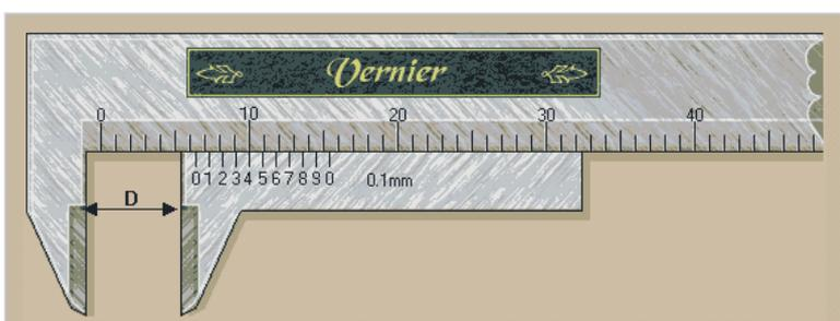
Utiliser un pied à coulisse classique pour déterminer le diamètre d'une masse fournie par le professeur . Noter la valeur.
