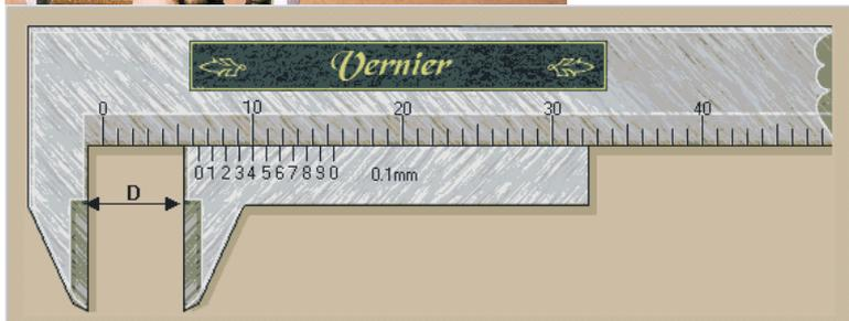
Utiliser un pied à coulisse classique pour déterminer le diamètre d'une masse cylindrique. Noter la valeur.
